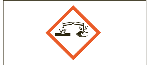
2 Das Gefahrensymbol «ätzend» weist auf ein grosses Risiko einer Hautschädigung hin. Hautschutzmassnahmen, sind zwingend notwendig, insbesondere das Tragen geeigneter Schutzausrüstung (z. B. Handschuhe).
